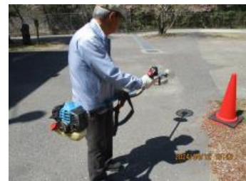
刈払機点検試運転
